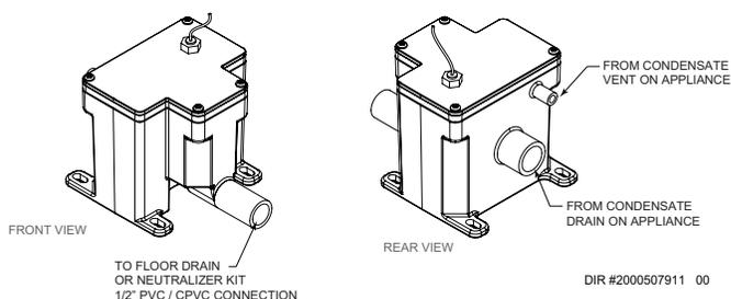
**AVERTISSEMENT** Le siphon de condensat doit être rempli d'eau pendant toute la durée de fonctionnement de la chaudière, pour éviter l'émission de gaz de combustion de la conduite de vidange du condensat. Le non remplissage du siphon pourrait provoquer des blessures corporelles ou la mort.
