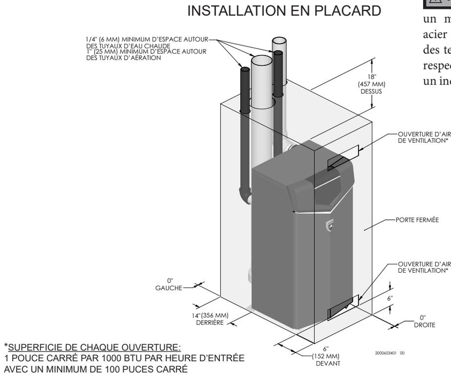
**⚠ AVERTISSEMENT** Pour les installations en placard, un matériel de ventilation en CPVC ou en acier inoxydable DOIT ÊTRE utilisé en raison des températures élevées. Tout manquement au respect de cet avertissement pourrait provoquer un incendie, des blessures corporelles ou la mort.
