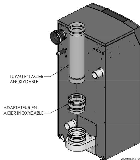
Tableau 3G Tuyau et raccords de ventilation en acier inoxydable
